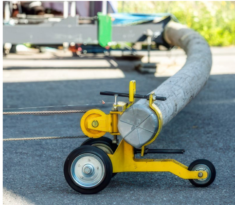
Hankkeessa taivuteltiin puupylväitä ja testattiin taivutuslujuudet räätälöidyn testauslaitteiston avulla. Kuva: XAMK
